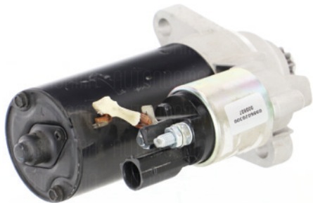
Keine Beschädigung des Steckers
